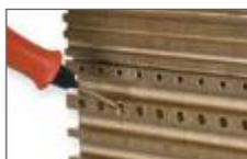
Cet outil mini est utilisé pour une super finition. Il inclut une lame triangulaire à 3 arêtes, extra fine et solide pour une super finition.
