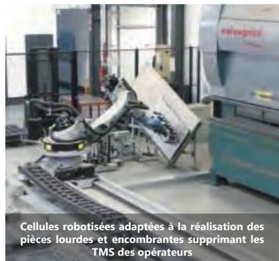
Cellules robotisées adaptées à la réalisation des pièces lourdes et encombrantes supprimant les TMS des opérateurs
