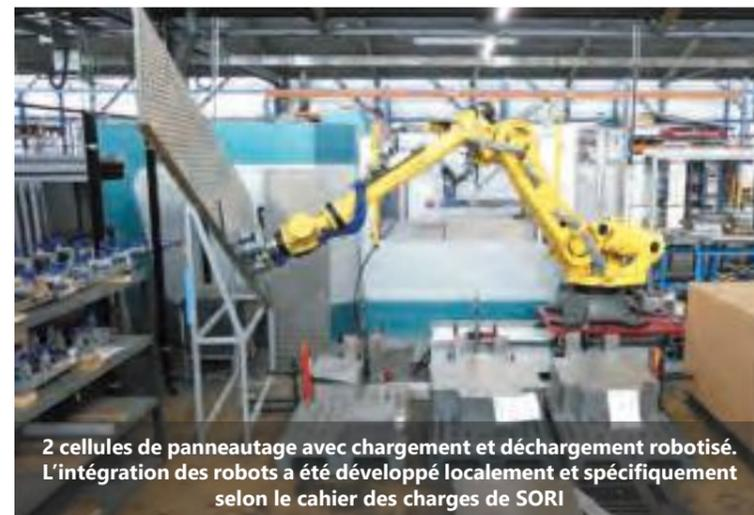
2 cellules de panneauage avec chargement et déchargement robotisé. L'intégration des robots a été développée localement et spécifiquement selon le cahier des charges de SORI
