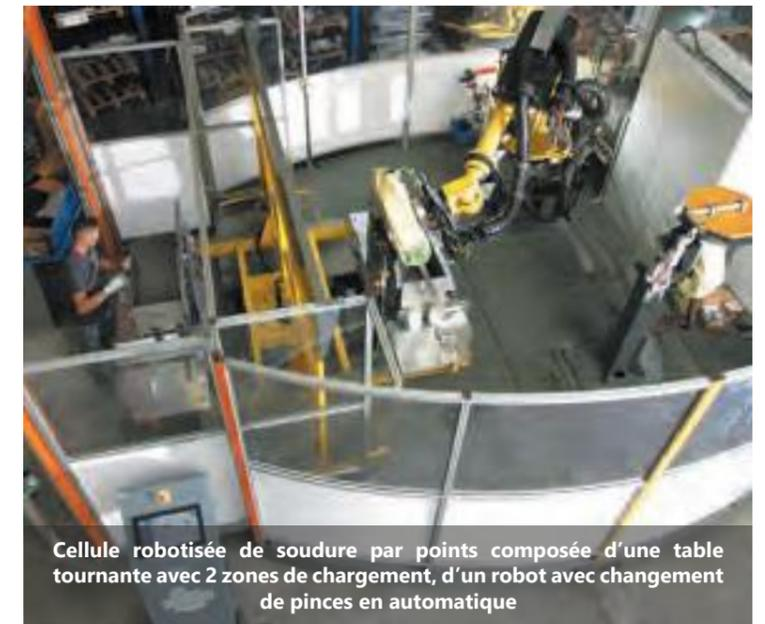
Cellule robotisée de soudure par points composée d'une table tournante avec 2 zones de chargement, d'un robot avec changement de pinces en automatique
