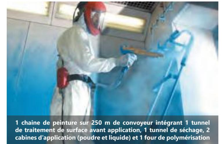
1 chaîne de peinture sur 250 m de convoyeur intégrant 1 tunnel de traitement de surface avant application, 1 tunnel de séchage, 2 cabines d'application (poudre et liquide) et 1 four de polymérisation
