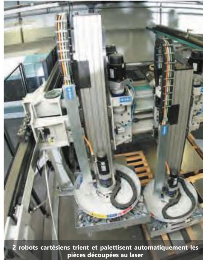
2 robots cartésiens trient et palettisent automatiquement les pièces découpées au laser
