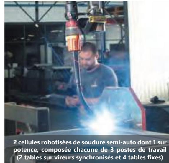
2 cellules robotisées de soudure semi-auto dont 1 sur potence, composée chacune de 3 postes de travail (2 tables sur vireurs synchronisés et 4 tables fixes)
