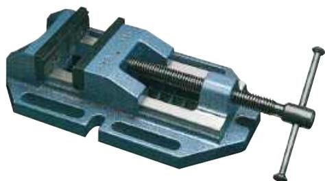
DOUBLE GUIDAGE DU MORS MOBILE. MORS EN ACIER TREMPÉ RECTIFIÉ. FIXATION LATÉRALE ET FRONTALE. SEMELLE FRAISÉE. MORS RÉVERSIBLE : MÂCHOIRE FIXE : 1 FACE RAINURÉE EN V VERTICALE ET HORIZONTALE POUR TUBE - 1 FACE STRIÉE. MÂCHOIRE MOBILE : 1 FACE LISSE - 1 FACE STRIÉE. DOUBLE GUIDAGE DU MORS MOBILE SUR LES FACES FRAISÉES. VIS ROULÉE MONOBLOC.
