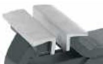
POUR LES TRAVAUX NÉCESSITANT UNE PROTECTION DES PIÈCES TRAVAILLÉES.
