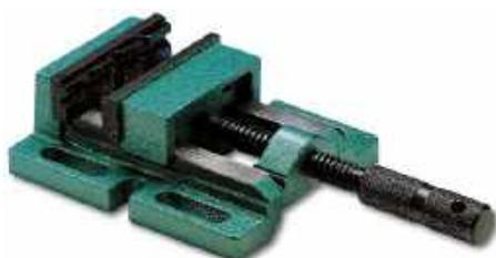
MORS EN ACIER TREMPÉ RECTIFIÉ. MÂCHOIRE MOBILE : 1 FACE LISSE, 1 FACE STRIÉE. MÂCHOIRE FIXE : 1 FACE RAINURÉE EN V VERTICALES ET HORIZONTALES, L'AUTRE FACE LISSE. FIXATION LATÉRALE.
