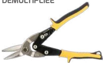
LAMES EN ACIER FORGÉ. TAILLANT AVEC MICRO DENTURE. POIGNÉE EN ACIER GAINÉE ABS ET ÉLASTOMÈRE ADHÉRENT. BUTÉE D'APPUI EN BOUT DE MANCHE. VERROUILLAGE PAR FERMOIR À ENCOCHE. CAPACITÉ DE COUPE : CUIVRE = 1,5 MM. ACIER DOUX = 1,2 MM. ACIER 35HRC = 0,8 MM. INOX 304 = 0,7 MM
