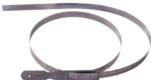
RUBAN ACIER AVEC VERNIER, GRADUÉ EN MM POUR LA
