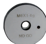
Bague filetée n'entre pas type 195 Tolérance 6g DIN 13 - NF E03-152
