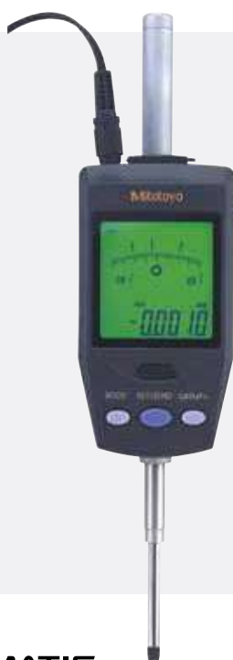
ID-H avec télécommande, câble de relevage de la broche et support avec table en acier trempé en option
